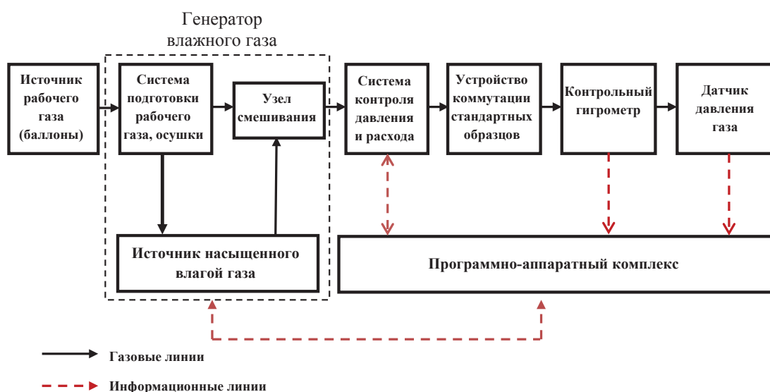
Рис. 2. Схема установки для заполнения стандартных образцов газовой смесью с известным содержанием ОДВ
