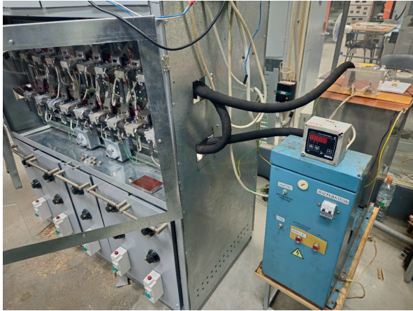
Рис. 5. Внешний охладитель радиатора
