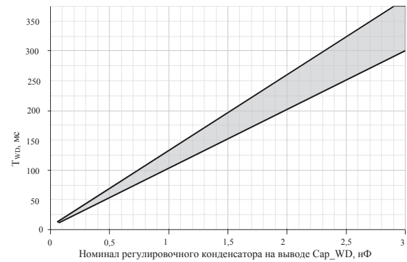
Рис. 11. Зависимость времени задержки срабатывания сторожевого таймера T_{WD} от номинала внешнего регулировочного конденсатора на выводе Cap_WD
