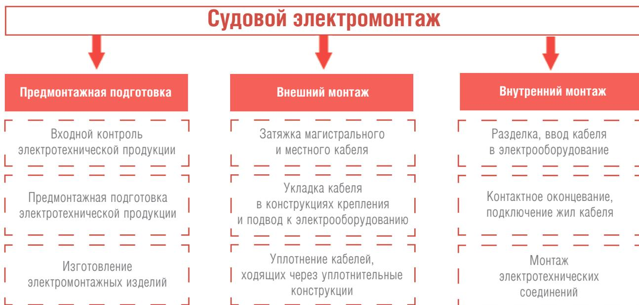
Рис. 1. Структура организации судовых электромонтажных работ
