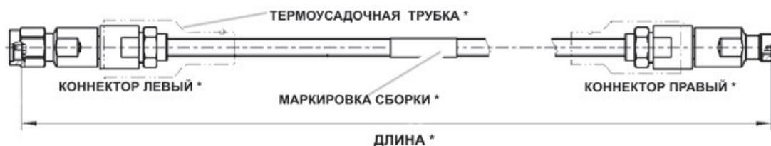
Рис 1. Схема кабельной сборки
