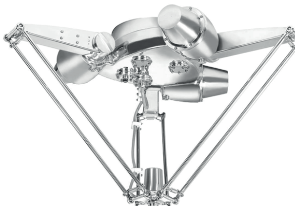
Рис. 2. Дельта робот (параллельный робот), применяемый в АПАК
