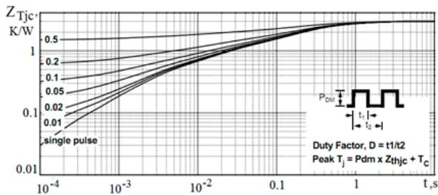
Рис. 2. Переходные характеристики при различных коэффициентах заполнения
