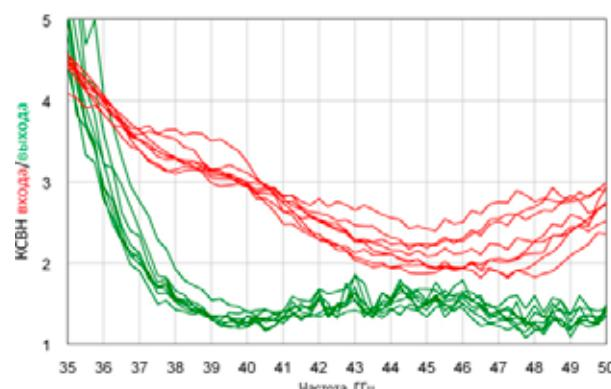
Рис. 4. КСВН входа и выхода
