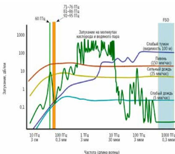
Рис. 1. Затухание радиоволн миллиметрового диапазона
