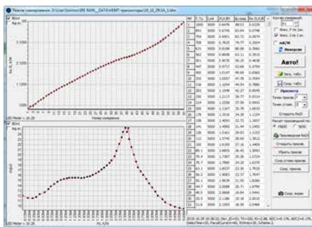
Рис. 7. Режим сканирования по частоте модуляции греющей мощности
