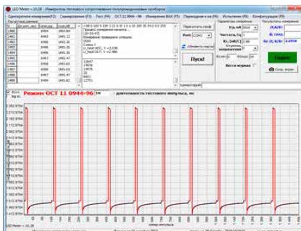
Рис. 9. Режим измерения теплового сопротивления согласно ОСТ 11 0944–96.
