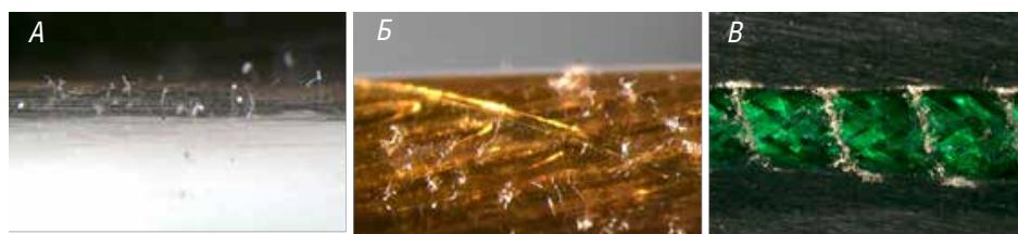
Рис. 1. Фото образцов проводов с разными поверхностями после испытания на воздействие плесневых грибов методом 1. (А. Полиэфирэфиркетон (2 балла), Б. Полиимидный лак (2 балла), В. Полиимидная пленка с подклеивающим слоем (4 балла)
