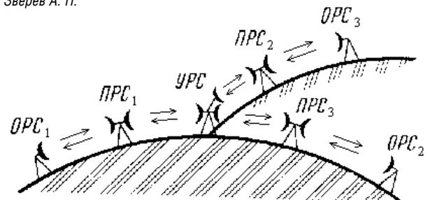
Рис. 2. Станции приёма и ретрансляции радиорелейных линий
