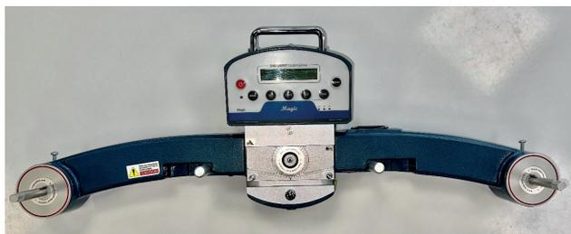
Рис. 2. Ручной счетчик электронных компонентов Magic M Component Counter
