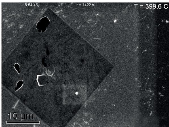
Рис. 6. СЭМ-изображение поверхности образца на 1422-й секунде эксперимента. Температура образца 400 °С, детектор вторичных электронов
