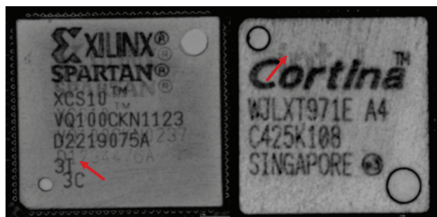
Рис. 1. Изображения корпусов микросхем, полученные с помощью акустического микроскопа. Вторичная маркировка
