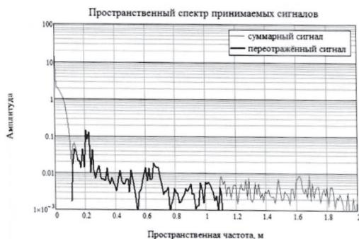
Рис. 5. Пространственный спектр сумм измеренных сигналов в диапазоне от 18 до 26,5 ГГц
