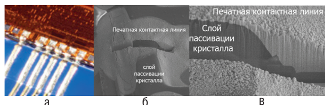
Рис. 4. Контактное печатное к выводам ИМС: а – вид печатных контактных линий сверху; б – РЭМ-изображение области контакта; в – FIB-срез соединения сфокусированным ионным пучком
