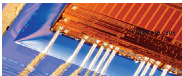
Рис. 3. Монтаж утоненного кристалла микросхемы памяти MX25 методом капле струйной печати
